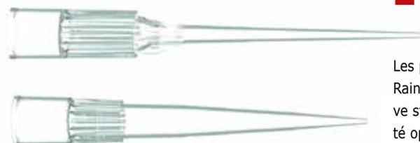
Les pointes de pipette et les pointes à filtre ont été conçues pour être utilisées avec les pipettes Rainin® LTS®. Le design innovant se caractérise par un col cylindrique avec une fonction "positive stop". Cela facilite la mise en place et le retrait de la pointe de pipette et assure une étanchéité optimale entre la pipette et la pointe.
